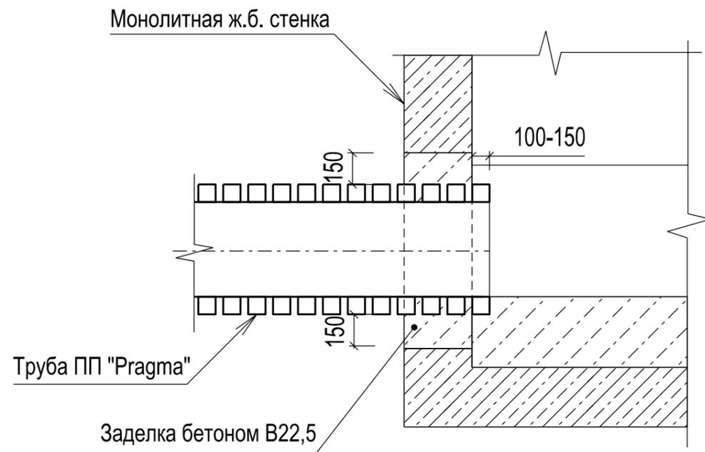
Узел присоединения трубопровода из ПП труб "Pragma" к типовым колодцам из сборного железобетона
