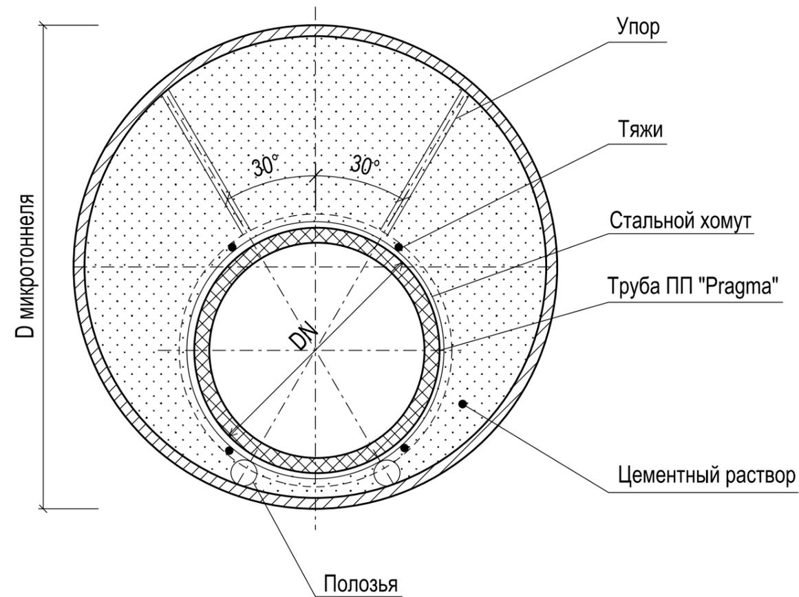
Конструкция ж.б. обоймы на ПП трубах "Pragma"
