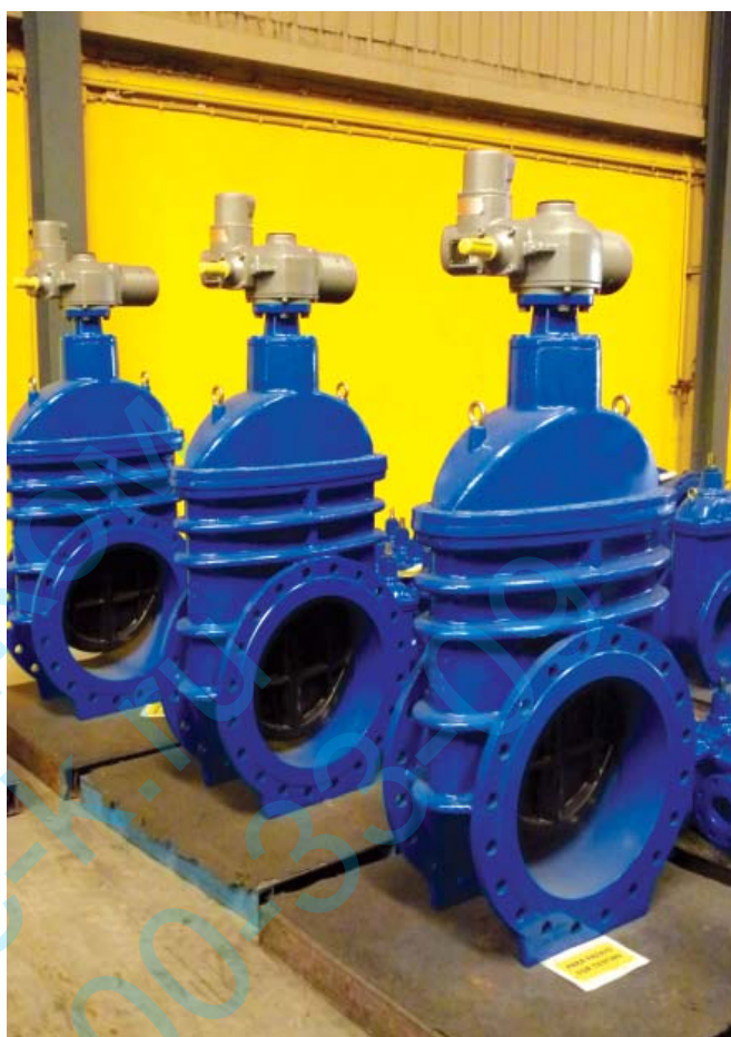
Задвижки Ду500 с электрическими приводами AUMA
