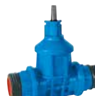
Серия 16/90 Ответвительная задвижка С соединителями "PRK" на концах DN 25-50 PN 16 Полиоксиметилен
