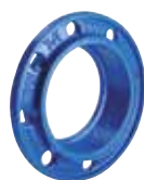
Серия 05 Фланец COMBI неупругий для труб из НПВХ, стали или ковкого чугуна. Материал – ковкий чугун. DN 400-600 для труб из НПВХ или ковкого чугуна. DN 50-300 для стальных труб PN 10/16
