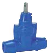
Серия 03/00 Ответвительная задвижка С внутренней резьбой для стальных труб DN 25-50 PN 16 Ковкий чугун
