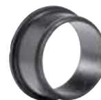
Серия 05 Уплотнение неупругое фланца COMBI, для труб из НПВХ, стали или ковкого чугуна. Материал – резина SBR. DN 400-600 для труб из НПВХ или ковкого чугуна. DN 50-300 для стальных труб
