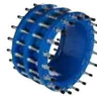
Серия 265/50 Соединитель демонтируемый Для всех типов труб С центральным фланцем Корпус из стали DN50-2200 PN10/16/25
