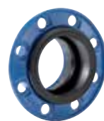
Серия 05 Обжимной чугунный фланец COMBI Устойчивый к растяжению Для труб из ПЭ и ПВХ DN 50-300 PN 10/16
