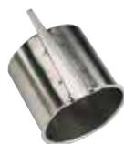
Серия 05 Опорная втулка для ПЭ труб Подходит для SupraPlus™, Supra Maxi™ и комби-фланцев DN 50-400 PN 6,3,10,16 Нержавеющая сталь AISI 304
