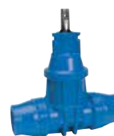
Серия 16/50 Ответвительная задвижка С муфтовыми соединениями устойчивыми к растяжению для труб ПЭ DN 25-50 PN 16 Полиоксиметилен
