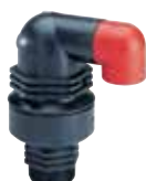
Серия 701/40 Комбинированный воздушный клапан DN20,25 и 50 С резьбой BSP , ¾",1" или 2" PN16 Армированный нейлон
