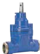
Серия 03/65 Ответвительная задвижка С обжимными фиксирующими соединителями для труб ПЭ DN 25-50 PN 16 Ковкий чугун
