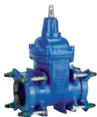
Серия 01/70 Клиновaя задвижка с соединительной муфтой Supa Plus™ для труб из НПВХ и ПЭ DN 40-300 PN 16 Ковкий чугун
