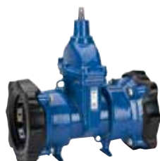
Серия 636 Задвижка Supa Maxi™ Универсальная и упругая для всех труб Ковкий чугун DN 80-200 PN 16
